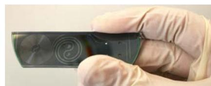
Puce microfluidique pour la détermination des conditions (P, T) de supercriticité.
